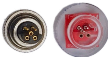
Stecker und Verbindungsstift der RSU-I Connector and connecting pin of the RSU-I
