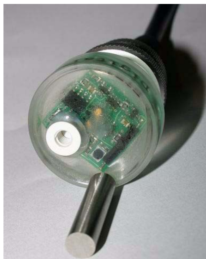
Position des Magneten für die Konfiguration
