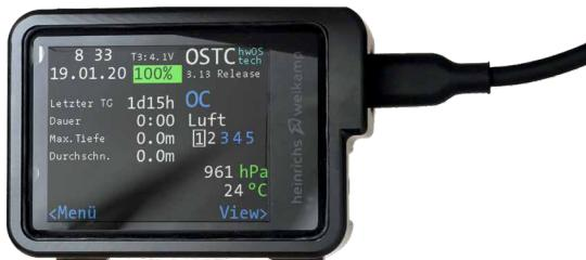
Der OSTC nano kommt ohne eigenes Ladepad aus, er wird über USB-C aufgeladen. Tauchgänge werden mit USB-C oder Bluetooth übertragen.
