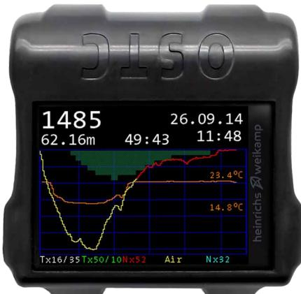
Bedient wird der OSTC 2 mit zwei Piezotastern. Das Logbuch kann bis zu 1000 Stunden speichern.
