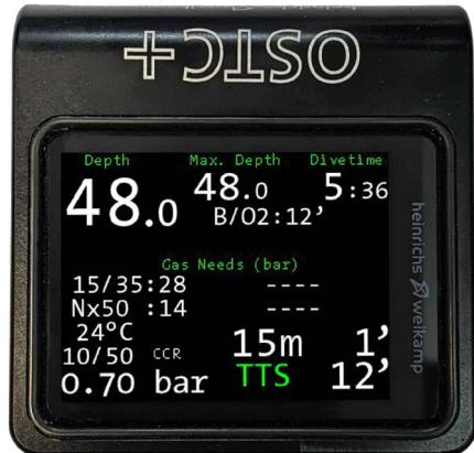
Das Display ist aufwendig optisch gebondet. Bedient wird der OSTC+ mit Sensorsternen, die in das Aluminium-Gehäuse integriert sind.
